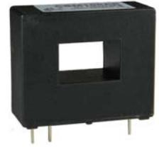
应用霍尔效应闭环原理的电流传感器，能在电隔离条件下测量直流、交流、脉冲以及各种不规则波形的电流。
