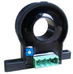
应用磁调制原理研制而成的一种新型电流传感器，能在电隔离条件下测量 mA 级直流小信号的电流。
