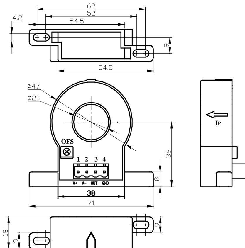
引脚说明: 1, +15V 2, -15V 3,  $V_{out}$  4, 0V(电源地) OFS, 零点调节
