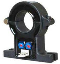
应用霍尔效应开环原理的电流传感器，能在电隔离条件下测量直流、交流、脉冲以及各种不规则波形的电流。
