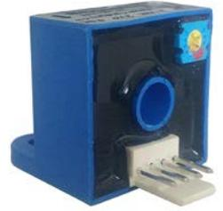
应用电磁感应原理的电流变送器，能在电隔离条件下测量交流信号电流，输出和被测电流有效值成比例的直流电压输出。
