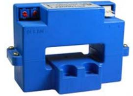
应用霍尔效应的电流变送器，能在隔离条件下测量交流信号电流，输出和被测电流有效值成比例的 4~20mA 直流电流输出。
