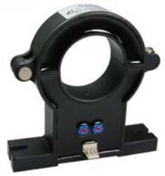
应用霍尔效应开环原理的电流变送器，能在电隔离条件下测量交流信号电流，转换成直流信号输出。
