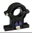
应用霍尔效应的电流变送器,能在电隔离条件下测量交流信号电流,输出和被测电流有效值成比例的 4-20mA 直流电流输出。
