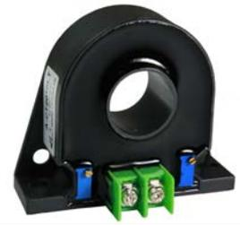
应用电磁感应原理的电流变送器，能在电隔离条件下测量交流信号电流，输出和被测电流有效值成比例的 4~20mA 直流电流输出。它们仅需两线制连接，无需单独的回路电源。
