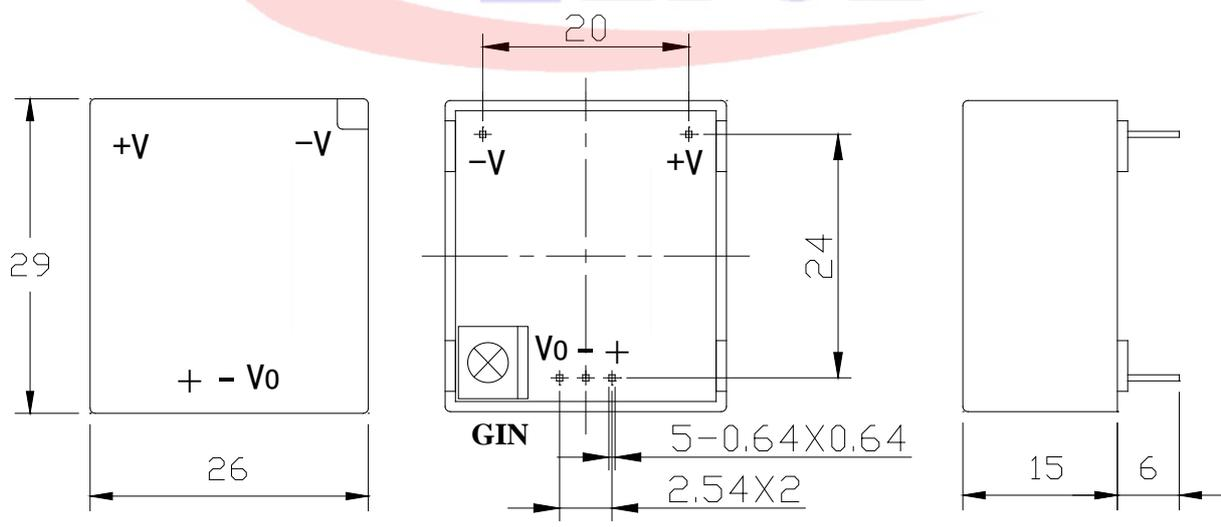
引脚说明: +V, 输入电压+ -V, 输入电压- +, +12V -, GND(电源地)  $V_0, V_{OUT}$  GIN, 幅度调节
