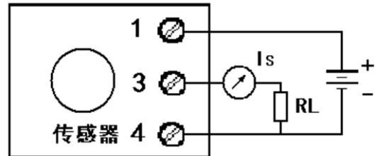
引脚说明：1: +24V 2: 0V(电源地) 3:  $I_{OUT}$  4: 0V(电源地) OFS: 零点调节 GIN: 幅度调节
