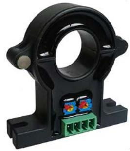
应用霍尔效应开环原理的电流传感器，能在电隔离条件下测量直流、交流、脉冲以及各种不规则波形的电流。
